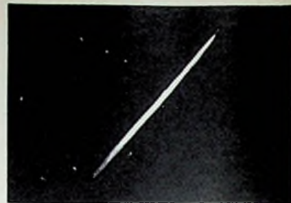
Afb. 11. Wanneer een mono-signaal naar de beide afbuigversterkers wordt gevoerd, zal een rechte lijn worden gevormd. Hoe smaller de lijn, des te kleiner de fasefouten in de stereo-keten zijn.
